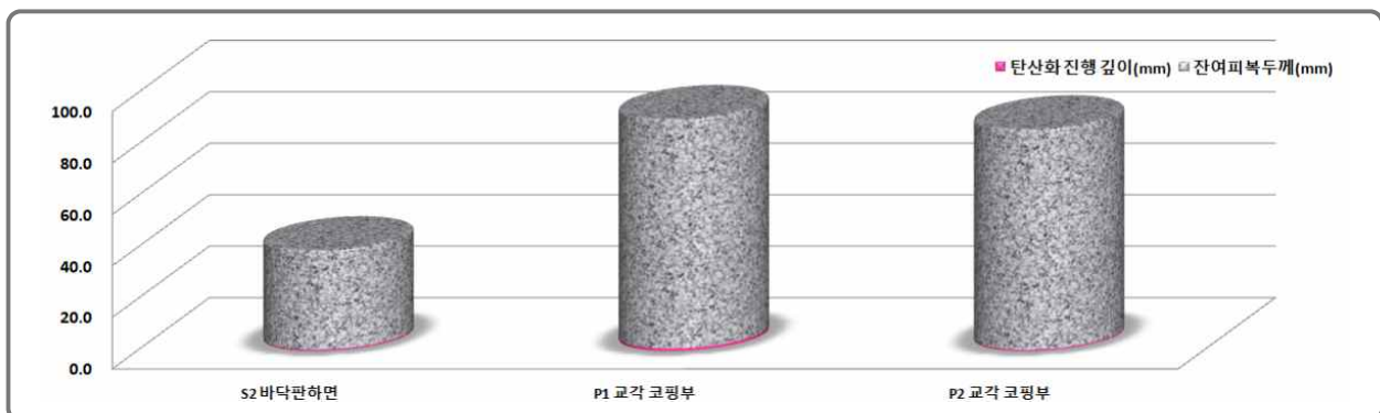
[그림 3.3.5] 탄산화깊이 및 잔여피복두께 측정결과
